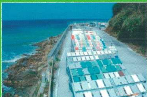
国立研究開発法人土木研究所の暴露試験場 (飛来成分が多く、年間を通して高温多湿)
