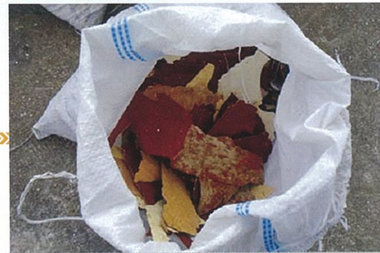
4 産業廃棄物は剥離した被膜のみです。
