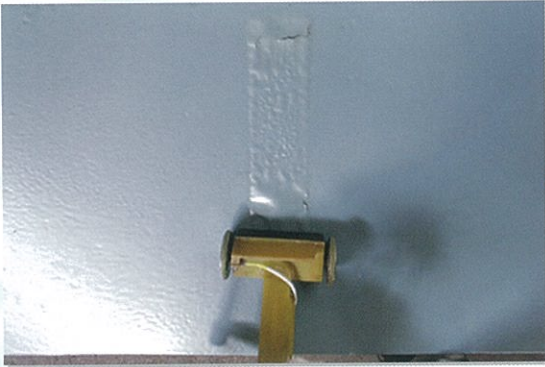
1 剥離したい箇所の被膜上に誘導ヘッドを通します。
